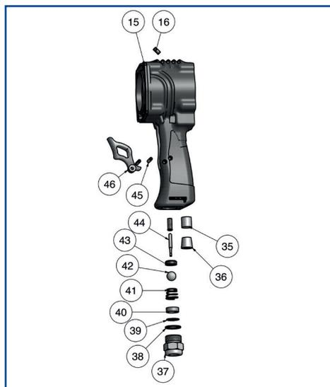
Solitamente l'impugnatura completa viene smontata solo esclusivamente per fare una revisione periodica, infatti nel Kit assistenza vengono forniti i componenti 38-43-45.
